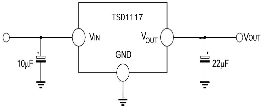
图 1. 典型固定输出电压
